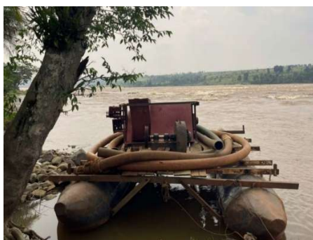
Figure 7 : Drague - site de Tshibrikita (province de Kasai)
